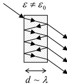
Fig. 7.32. Dielectric Fabry-Pérot interferometer.
